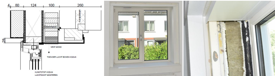
Figuur 12 Raamconstructie. Bron: Dura Vermeer 15-4-2016
