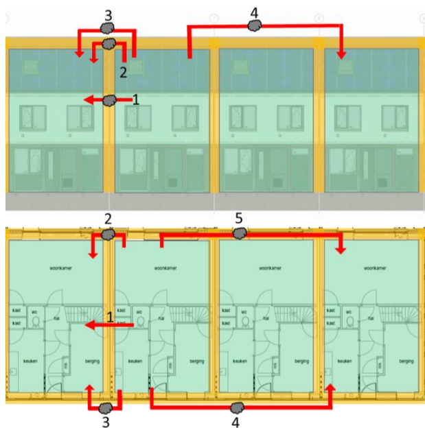
Figuur 96 Mogelijke trajecten van rookverspreiding
