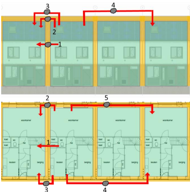
Figuur 90 Mogelijke trajecten van rookverspreiding
